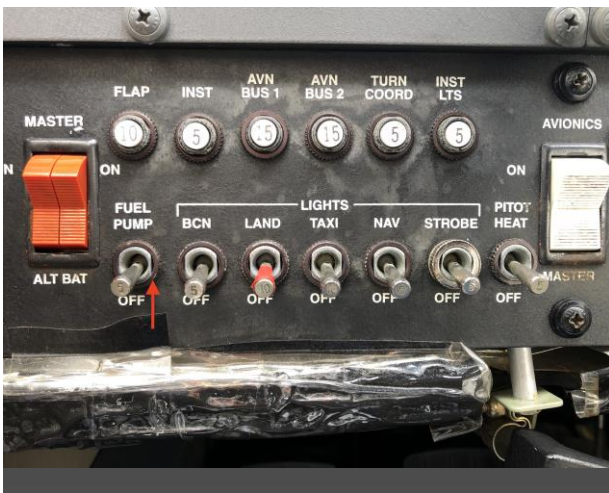
FIG. 6 - POMPE AUXILIAIRE SUR ON
